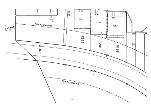
Abb. 2 Derselbe Ausschnitt aus dem Grundbuchplan. Die Baulinien werden in den Grundbuchplan übertragen, sobald sie rechtskräftig sind.
