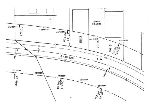
Abb. 1 Ausschnitt aus einem Baulinienplan 1:500. Die Nummern der Baulinienpunkte beziehen sich auf ein Koordinatenverzeichnis, das am Rande des Baulinienplanes steht.
