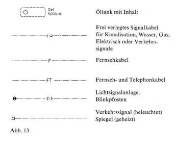
Abb. 7 bis 13 Signaturen im Leitungskataster Meilen. Ergänzung und Präzisierung der SIA-Richtlinien Nr. 149 (7).
