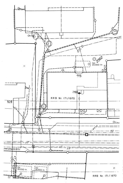
Abb. 6 Leitungskataster 1:250. Es handelt sich um denselben Ausschnitt wie in Abb. 5. Der Grundbuchplan wurde photographisch vergrössert und zum Leitungskataster ergänzt.
