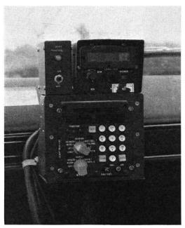
Abb. 2 Anzeige- und Kontrolleinheit im Fahrerraum des Messfahrzeuges.
