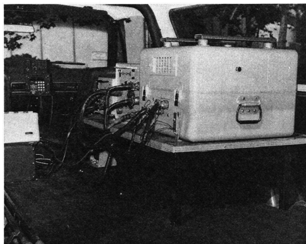
Abb. 1 In Fahrzeug eingebautes Trägheitsvermessungssystem «Auto-Surveyor». Von links nach rechts: Kassetten-Tonbandgerät, Anzeige- und Kontrolleinheit, Rechnereinheit, Speisegerät, Trägheitsmesseinheit.
