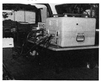
Abb. 1 In Fahrzeug eingebautes Trägheitsvermessungssystem «Auto-Surveyor». Von links nach rechts: Kassetten-Tonbandgerät, Anzeige- und Kontrolleinheit, Rechnereinheit, Speisegerät, Trägheitsmesseinheit.
