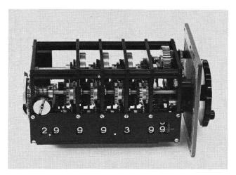
Abb. 10 Zählwerk des Mekometers
