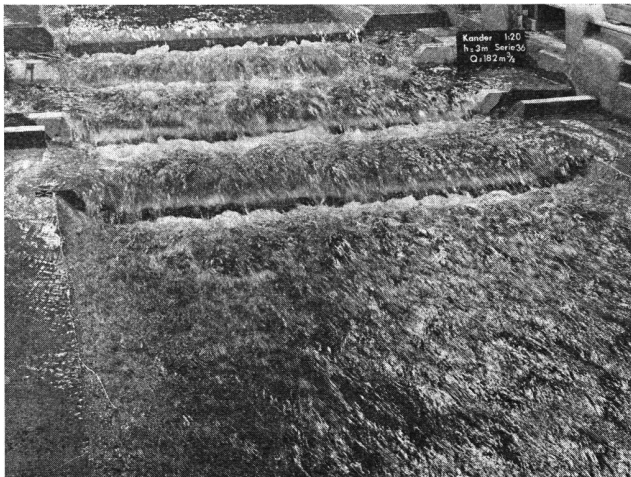
Modell Kander, Sperrentreppe. Wasseroberfläche bei Durchfluss von Q_{\max} = 183 \text{ m}^3/\text{s} .
