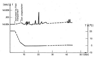
Abbildung 19 DM 500: Abhängigkeit der Grobfrequenz f von Temperatur T und Zeit t. Die Messungen bei 20 °C erfolgten nach der Versuchsanordnung B, jene im Freien bei 0 °C nach der Anordnung C. Es sind alle wesentlichen Frequenzänderungen aufgetragen (Intervall der Ablesung der Frequenz: 10 Sekunden). 23.12. 74.
