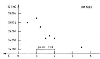
Abbildung 14 Distanzmessungen mit DM 500 bei verschieden starkem Empfangssignal und bei konstanter Blendenstellung. Die Intensität des Signals wird durch photographische Filter abgeschwächt. D = Distanz in Meter. E = Einheit des Anzeigeinstrumentes (Null: rechts, 10: links).
