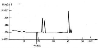
Abbildung 18 DM 500: Abhängigkeit der Grobfrequenz f von der Zeit t. Versuch C: Dauermessung. Intervall der Ablesungen der Frequenz: 1 bis 5 Minuten; extreme Werte werden zusätzlich erfasst. 23. 12. 74,  $T=20.5\,^{\circ}\text{C}$ .
