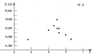
Abbildung 15 Distanzmessungen mit DI 3 bei verschieden starkem Empfangssignal. Abschwächung des Empfangssignals durch photographische Filter. D = Distanz in Meter. E = Einheit des Galvanometers.
