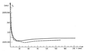
Abbildung 23 Geodimeter 6 BL: Abhängigkeit der Frequenz  $f_2$  von der Zeit t nach Anschliessen der Batterie und Einschalten des Gerätes. Ausgezogene Kurve: 19.12.74,  $T=21\,^{\circ}\text{C}$ . Gestrichelte Kurve: 20.12.74,  $T=20\,^{\circ}\text{C}$ .
