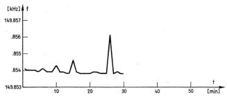
Abbildung 16 DM 500: Abhängigkeit der Grobfrequenz f von der Zeit t. Versuch A: Mehrmalige Distanzmessungen, Distanzmesser dazwischen nicht ausgeschaltet. Datum: 23. 12. 74. Temperatur  $T=20.5\,^{\circ}\text{C}$ . Der Nullpunkt der Zeitskala fällt mit dem Einschalten des Distanzmessers zusammen.
