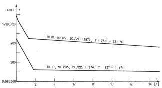
Abbildung 22 DI 10: Abhängigkeit der Messfrequenz von der Zeit t. Versuch C: Dauermessung der Messfrequenz.
