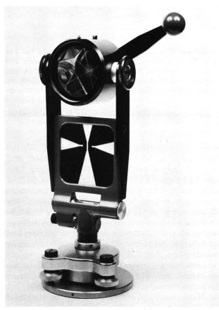
Abbildung 4 Versuchs-Zielmarke mit Reflektor zu Mekometer. Die Zielhöhe ist wie beim bestehenden DKM2-A auf 171 mm eingestellt, die Kippachshöhe des Reflektors stimmt mit derjenigen des Mekometers überein. Die Zielhöhe lässt sich prinzipiell mit einer Genauigkeit von ± 0,1 mm auf jede Kippachshöhe eines Theodolits bringen.
