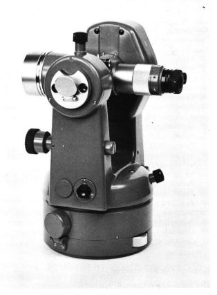
Abbildung 3 Versuchs-DKM2-A mit konstanter Kippachshöhe von 190,0 mm über dem versicherten Punkt. Die Kippachshöhe lässt sich auf  $\pm$  0,1 mm abstimmen.
