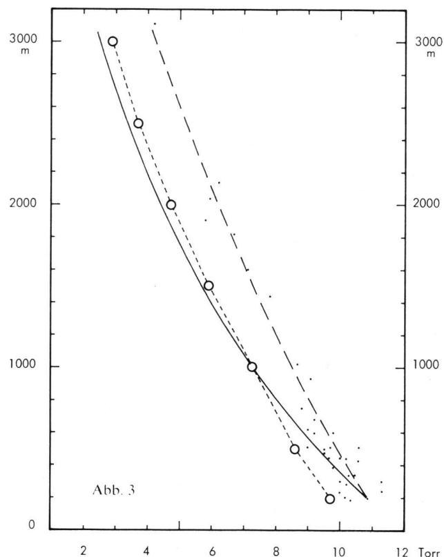
Konnte man bei der Temperatur feststellen, dass Tagesmittelwerte am Boden und in der freien Atmosphäre im Durchschnitt übereinstimmen, so lehrt Abbildung 3, dass beim Dampfdruck die Tagesmittelwerte am Boden immer grösser sind als in gleicher Höhe der freien Atmosphäre. Dasselbe Bild ergibt sich, wenn man der Analyse nicht Tagesmittel der Feuchte, sondern 14<sup>h</sup>-Werte zugrunde legt. Die Wiedergabe muss hier aus Platzmangel unterbleiben (siehe [4]).
