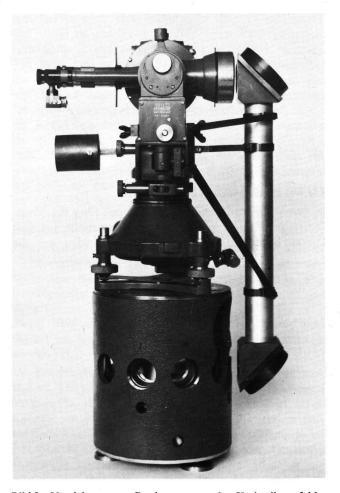
Bild 2 Vorrichtung zur Bestimmung totaler Kreisteilungsfehler des Theodolits Wild T3 mit Hilfe eines Spiegelpolygons
