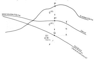
Abbildung 1 Geoid und Referenzellipsoid, stark überhöht dargestellt
