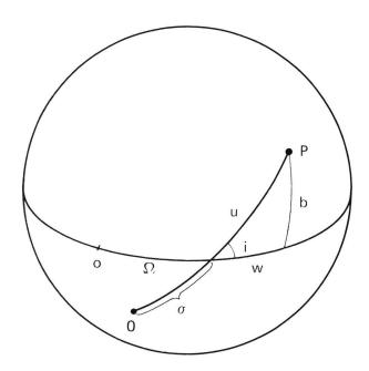
Die anschauliche Bedeutung der neu eingeführten Grössen i, u,  $\sigma$ , w und  $\Omega$  ist der Figur zu entnehmen. Das «ungestörte» Problem ist die geodätische Linie auf einer Kugel ( $e^2=0$ ). Variiert s, so durchläuft der Punkt P die geodätische Linie, einen Grosskreis mit der Neigung i gegen den Äquator und der Knotenlänge  $\Omega$ .
