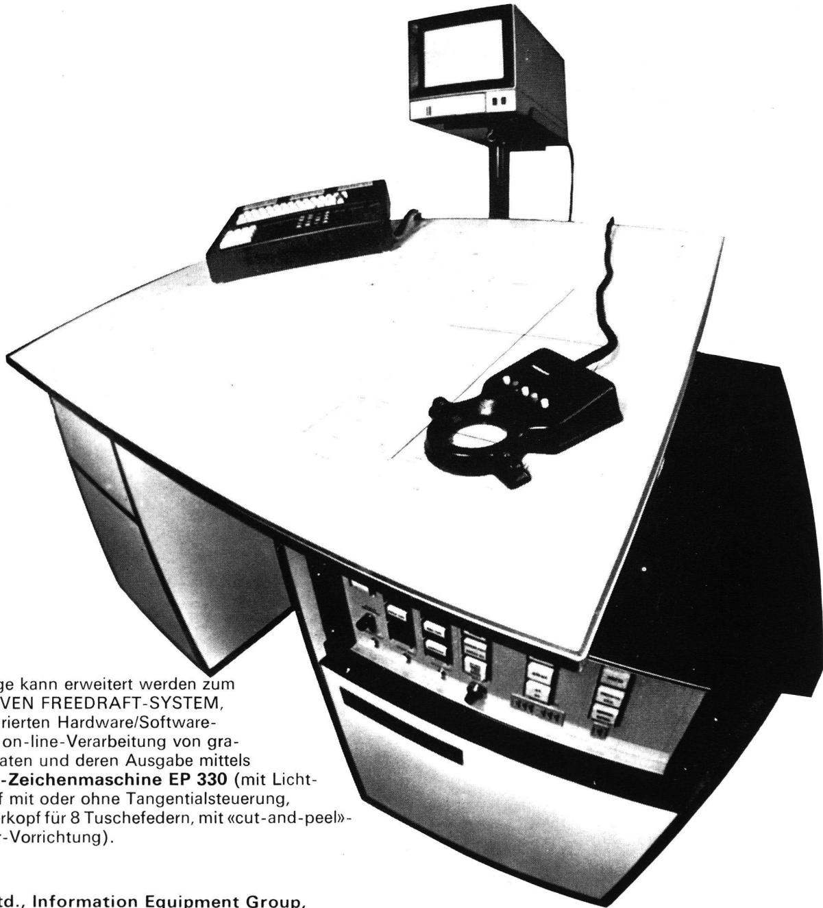
Diese Anlage kann erweitert werden zum INTERAKTIVEN FREEDRAFT-SYSTEM, einem integrierten Hardware/Software-System zur on-line-Verarbeitung von grafischen Daten und deren Ausgabe mittels **Präzisions-Zeichenmaschine EP 330** (mit Lichtzeichenkopf mit oder ohne Tangentialsteuerung, mit Revolverkopf für 8 Tuschefedern, mit «cut-and-peel»- und Gravier-Vorrichtung).
