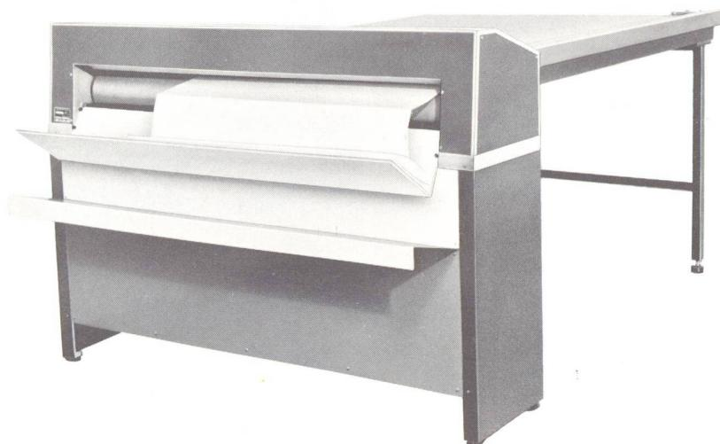
Kombinierte Belichtungs- und Entwicklungs- maschine für Ammoniak-Entwicklung. Automatische Trennung von Original und Lichtpauspapier. **Typ Admel International 3500**, Quarzbrenner 3,5 KW; **Typ Admel International 5003**, Quarzbrenner 5 KW, umschaltbar auf 3 KW.
