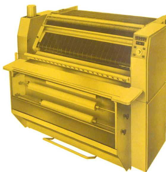
Kombinierte **Hochleistungs-Lichtpausmaschine** eigener Konstruktion für das Halbtrockenverfahren, **Modell AEL 3,5**, Arbeitsbreite 130 cm, Quarzbrenner 3,5 KW, umschaltbar auf 2,5 KW.
