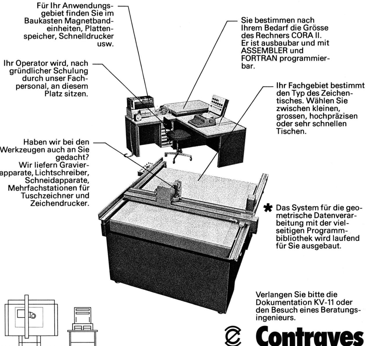
Das Koordinatenlesegerät Contraves CODIMAT kann on-line oder off-line zum System CORAGRAPH DC 2 eingesetzt werden.
