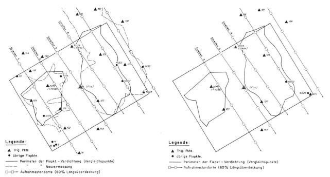
Abb. 2 Paßpunktverteilung Swissair Photo und Vermessungen AG,
