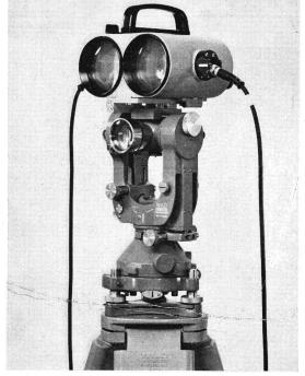
Wild DI 3 Reduzierender IR-Tachymeter mit einer Reichweite bis etwa 900 m. Vollautomatische Distanzmessung und Anzeige von Horizontaldistanz und Höhenunterschied nach Eingabe des V-Winkels.
