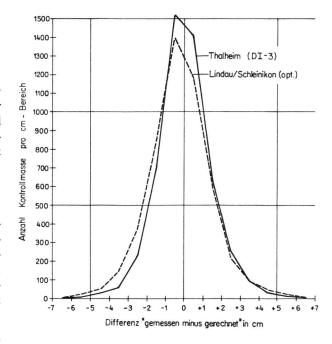
Erwartungsgemäß ist die Anzahl der Kontrollmaße in der Umgebung der Differenz 0 bei der DI-3-Vermessung größer. Bekanntlich wird der überwiegende Teil der Kontrollmaße zu lang gemessen, da Ungenauigkeiten infolge von Band-
