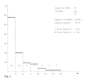
avec un théodolite à secondes (quatre séries complètes sur chaque station) et complété par quelques mesures avec le Distomat Wild DI10.
