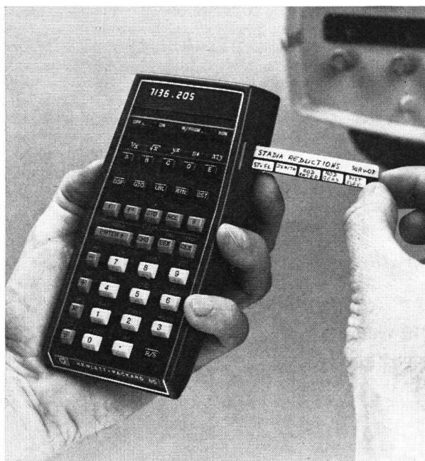
Les géomètres, topographes, spécialistes en génie civil peuvent mettre au point sur le HP-65, nouveau calculateur de poche programmable et à cartes magnétiques, leurs propres applications ou utiliser pour les problèmes les plus courants, la bibliothèque de programmes pré-enregistrés, développée par Hewlett-Packard. Le clavier du HP-65 offre 51 fonctions au total.
