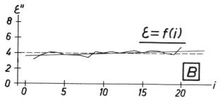
Abb. 3 Versuch B. Meßreihe mit dem NA2 am 3. Februar 1972. i: Laufende Nummer der Messung. ε: Neigung der Zielachse. Gestrichelt: mittlere Zielachsenneigung. Ausgezogene Gerade: ausgleichende Gerade (Regressionsgerade)
