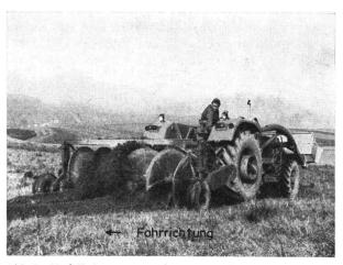
Abb. 9 Verfüllschnecke an Traktor, Eigenkonstruktion des Unternehmers. Verfüllen eines 26 cm breiten Grabens (sandiger Lehm). Baujahr 1967; Gewicht 900 kp (ohne Traktor); Schneckenlänge je 1100 mm; Arbeitsgeschwindigkeit bis 1,5 km/h. Anschaffungspreis: Traktor 50000.—; Schnecke ca. Fr. 8000.—.
