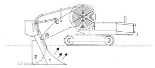
Abb. 2 Prinzipskizze, Querschnitt «Böhler Drainomat grabenlos» (siehe auch 1.3).
