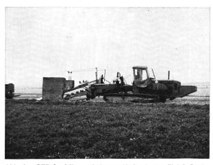
Abb. 6 «GFP 2». Mit angehobenem Verlegekasten (links). In der Mitte ist das Fräswerkzeug, rechts der Maschinenteil mit der Kabine für den Fahrer erkennbar.
