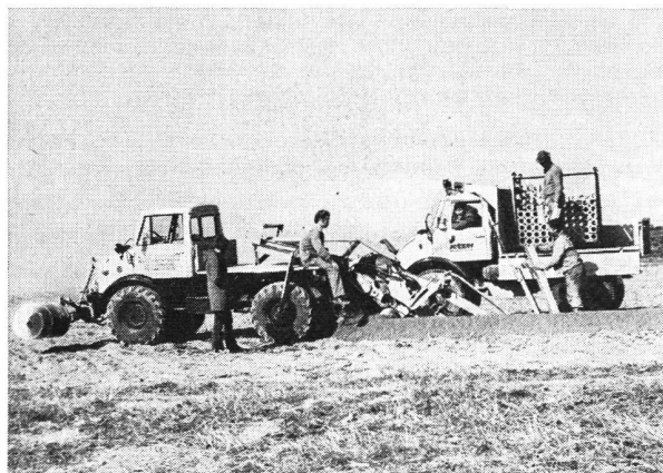
Abb. 7 «Hoes» zu Unimog. Einsatz in Hügelland (sandiger Lehm), Grabentiefe 1,1 m; Rohrmaterial: Ton Ø 80 mm.
