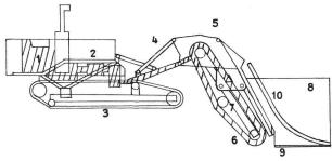
Abb. 1 Prinzipskizze, Querschnitt «Hoes Gigant». 1 Motor / 2 Getriebe / 3 Raupenlaufwerk / 4 Arbeitsbaumausleger / 5 Arbeitsbaum mit: / 6 Fräskette / 7 Räumschnecken / 8 Verlegekasten / 9 Sohlenausformer / 10 Rohrverlegerutsche (siehe auch Abb. 3, 4, 6).
