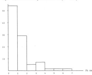
Fig. 3 Double levé: histogramme des écarts altimétriques
