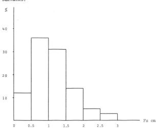
Fig. 2 Double levé: histogramme des écarts planimétriques
