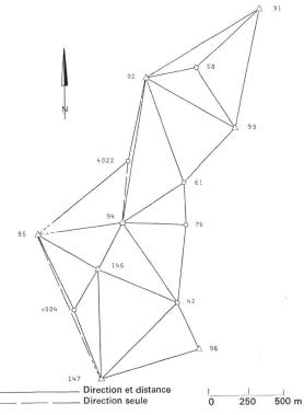
Fig. 1 Réseau de base du syndicat d'Oulens
