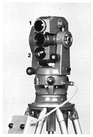
b) Objektivseite: 1 Senderobjektiv; 2 Empfängerobjektiv mit Infrarotfilter und Blendenring.
