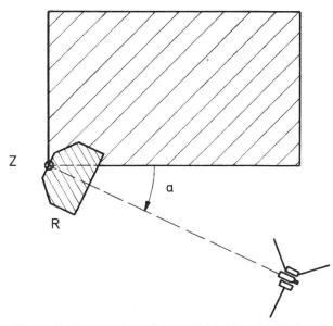
Abb. 3 Als Zentrum des Reflektors gilt derjenige Punkt, dem die Additionskonstante null des Distanzmessers zugeordnet ist. Das Zentrum Z des Reflektors R kann in der dargestellten Aufnahmesituation bei zu kleinem Winkel a nicht in die Gebäudeecke gebracht werden.
