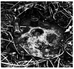
benutzte man eine am Institut hergestellte Zentriermarke, welche in die Bolzen der Sockel eingefügt werden konnte. Sowohl die Distanzmessungen mit dem Mekometer ME 3000 als auch die anschließenden Beobachtungen der Höhenwinkel mit dem DKM 2-A verliefen rasch und reibungslos. Für die Richtungsmessungen, ebenfalls mit dem DKM 2-A durchgeführt, benötigte man einen zusätzlichen Tag, so daß die Beobachtungen im Netz Pardiala innert zweier Tage abgeschlossen werden konnten. Insgesamt wurden gemessen:
