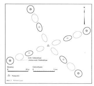
ist ersichtlich, daß die Hauptachsen der mittleren Fehlerellipsen a posteriori durchwegs kleiner sind als 0,2 mm.
