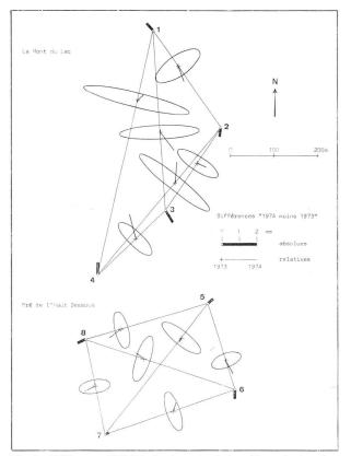
Fig. 2 Différences 1973/74 absolues et relatives ( $P_i - P_i$ , i > j) et ellipses d'erreur moyenne relatives
