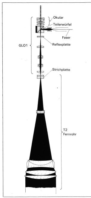
Abb. 2 Optikschema des Laserokulars GLO1
