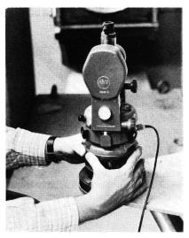
Abb. 13 Neigungsmessung von CERN-Büchsenachsen Stecklibelle, Libelle mit Mikrometerschraube (Wyler) und Zwischenplatte für die Verwendung als Stecklibelle, Neigungsmessung mit einem DKM2-A (v.l.n.r.)
