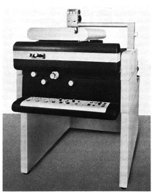
Abb. 3 Orthophoto-Projektionseinheit
