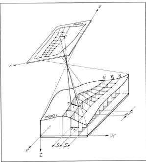
Abb. 1 Geometrisches Prinzip
