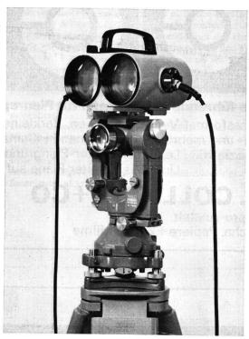
**Wild DI 10**,IR-Tachymeter mit einer Reichweite bis etwa 2000 m. Automatisch einund nachlaufende Anzeige.
