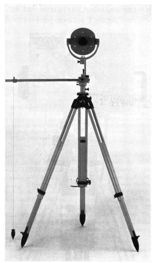
Abb. 3 Ablegegerät Zeiss ASG
