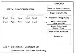
Abb. 4 Schematische Darstellung von Speicherinhalt und Key-Zuordnung
