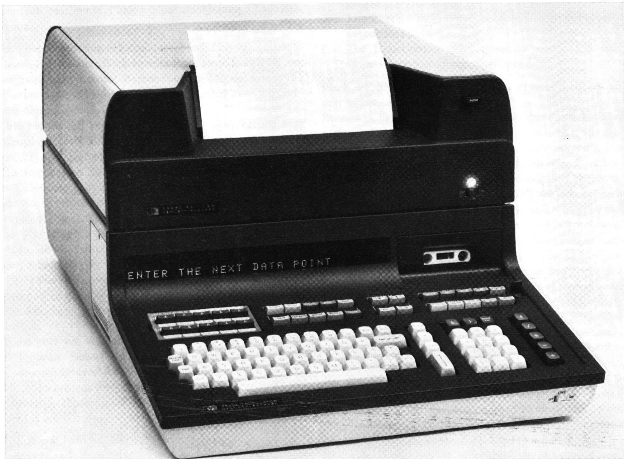
Abb. 1 Tischcomputer HP 9830 A mit aufgesetztem Thermoprinter 9866 A
