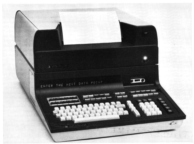
Abb. 1 Tischcomputer HP 9830 A mit aufgesetztem Thermoprinter 9866 A
