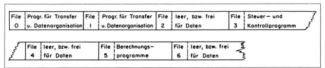
Abb. 3 Schematische Darstellung der Organisation des Magnetbandes «Nachführung»
