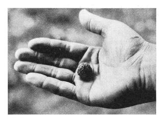
Abb. 3 Eine Schwammgummikugel, wie sie für Milchleitungen vom Kaliber 11 mm verwendet wird
