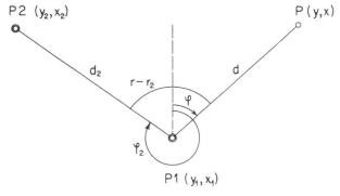
Abb. 1. Konfiguration bei der Polaraufnahme
