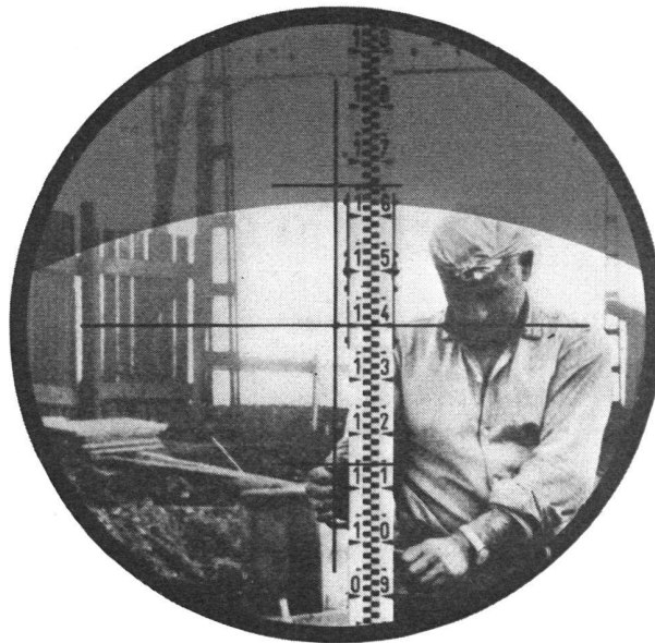
Abb. 2 Bei ungenügender Grobhorizontierung erscheint im Fernrohrsichtfeld die Warnblende
