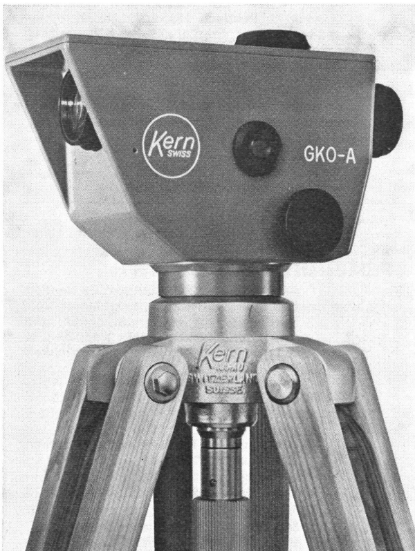
Abb. 1 Automatisches Baunivellier Kern GKO-A auf dem Gelenkkopfstativ
