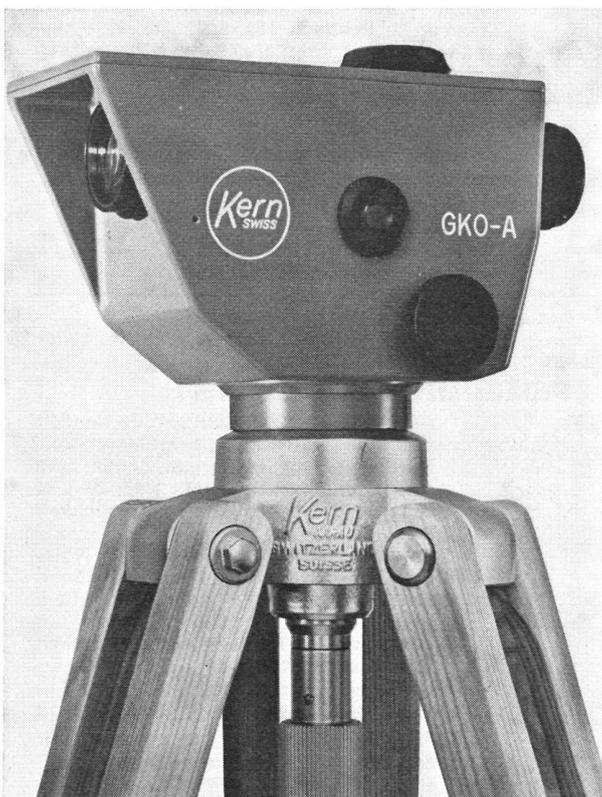
Abb. 1 Automatisches Baunivellier Kern GKO-A auf dem Gelenkkopfstativ
