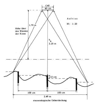
Abbildung 4: schematische Darstellung der Aufnahmedisposition
