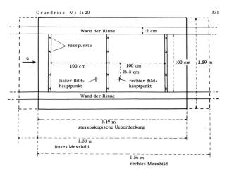
Abbildung 4: schematische Darstellung der Aufnahmedisposition
