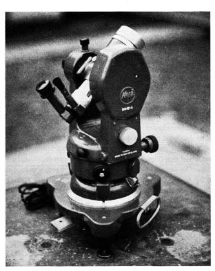
Abb. 1 DKM2-A mit angebrachten gebrochenen Okularen
