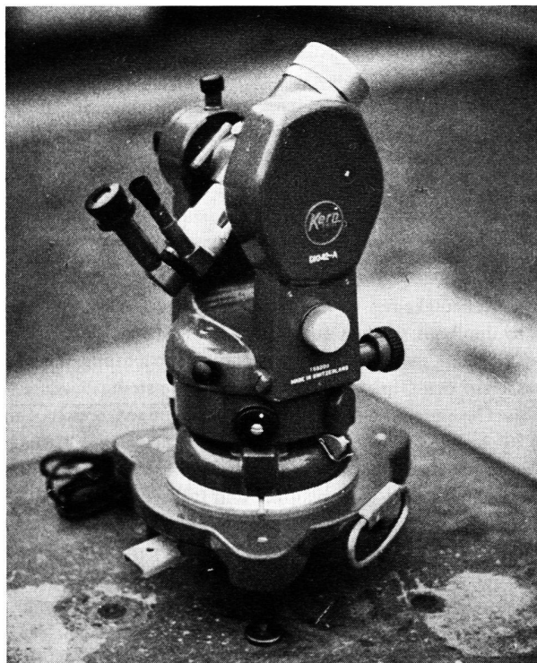
Abb. 1 DKM 2-A mit angebrachten gebrochenen Okularen
