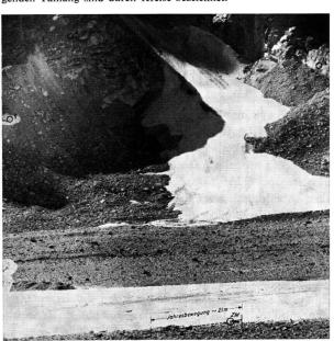
wir bei den im Auftrag der Kraftwerke Oberhasli AG alljährlich durchgeführten Aaregletschervermessungen dazu übergegangen, die Bewegungen von Zielmarken auf dem Eis des Unteraargletschers mit einer automatischen Kamera photographisch in kurzen, festen Zeitabständen aufzunehmen.
