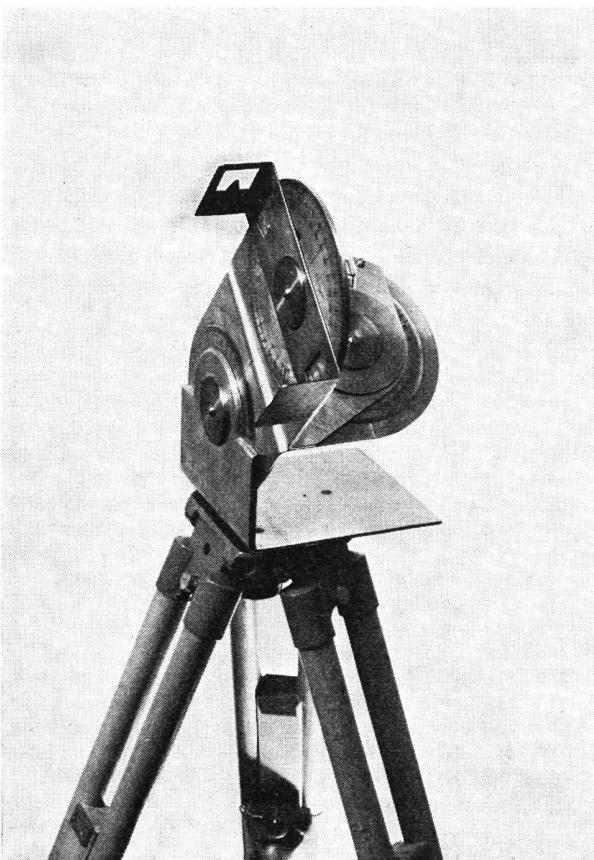
übereinstimmt. Nun sollte, wenn das Instrument nach Süden orientiert wäre, die Visur zur Sonne gerichtet sein. Diese fehlende Orientierung finde ich mit Hilfe der «Lochkamera», indem ich das ganze Instrument um die Vertikalachse des Zentrierstockes drehe, bis das Sonnenbild auf das Visierloch zentriert ist. In dieser definitiven Lage klemme ich das Ganze auf dem Stativ fest.
