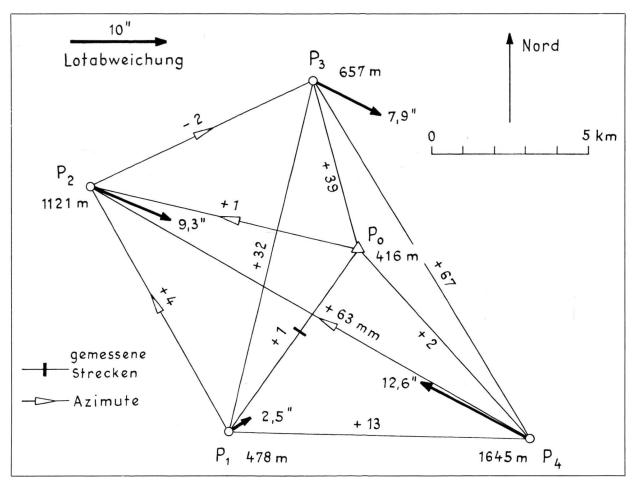
Abb. 1 Raumnetz Heerbrugg: Lotabweichungen, ellipsoidische Höhen und Änderungen der ausgeglichenen Raumstrecken in Millimeter bei Ausgleichung ohne Lotabweichungen
