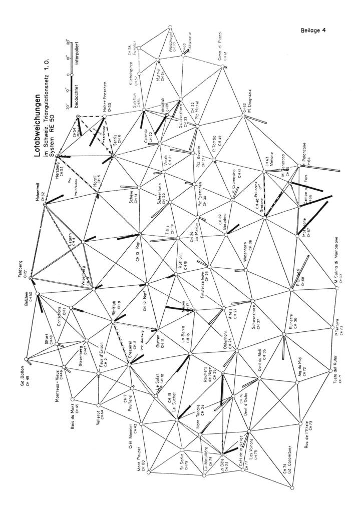
den Oberflächenpunkten im schweizerischen Bezugssystem; mit den angegebenen Korrekturen werden diese ins System RE 50 übergeführt.
