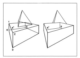
Abb. 5 Die Bestimmung der nicht sichtbaren Teile von Körpern erfolgt so, daß bei sämtlichen Strecken in der Projektionsebene untersucht wird, ob deren Mittelpunkt durch eine Körperfläche verdeckt wird. Im gezeigten Fall ist beispielsweise der Mittelpunkt der Teilstrecke  $\overline{44^1}$  durch die Fläche  $\overline{1234}$  verdeckt (linkes Bild) und somit unsichtbar (rechtes Bild), während die Teilstrecke  $\overline{4^15}$  sichtbar bleibt, weil die Oberseite des Quaders offen ist
