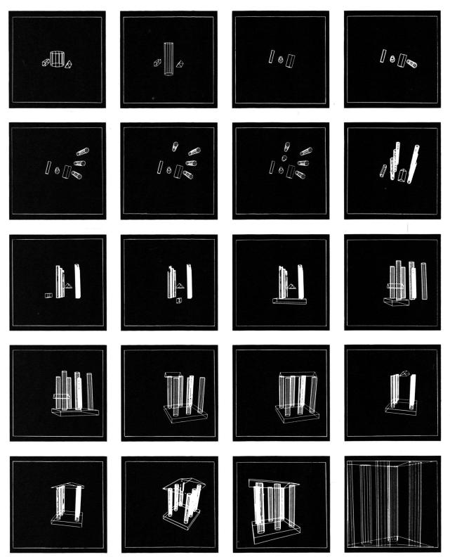
Abb. 4 Konstruktion eines griechischen Tempels am Bildschirm im interaktiven Verfahren. Die benötigten Konstruktionselemente werden zunächst aus einer Bibliothek abgerufen. Mit Keyboard und Light Pen werden die einzelnen Elemente schrittweise dimensioniert, positioniert und zusammengesetzt (Scientific American Juni 1970)
