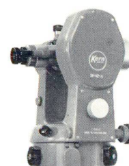
Kern DKM 2-A Sekundentheodolit mit automatischer Höhenkollimation
