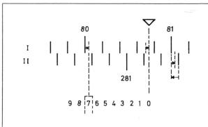
Abb. 11c, d Ablesung diametraler Kreisstellen mit Hilfe eines Mikrometers.
