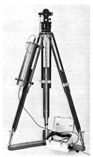
Abb. 18 DKM2-AL. Laserstrahl in das Fernrohr eingeblendet.
