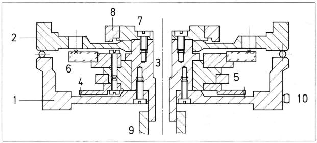
Spiel zwischen Zapfen und Bohrung, insbesondere abhängig von der Verteilung des Schmiermittels im Raum zwischen Zapfen und Bohrung. Im Gegensatz dazu hängt die Genauigkeit eines Achsialkugellagers nur von der Ebenheit der Lauffläche und den Durchmessern der Kugeln ab.
