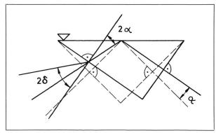
Abb. 14 Schematischer Strahlengang im Kompensator.
