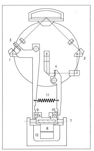
Abb. 9 Schema des Höhenkreismikrometers. Eine Kreismarke im Strahlengang zeigt an, daß der Strahl auf den Betrachter zukommt; eine Kreuzmarke zeigt, daß der Strahl vom Betrachter wegläuft.
