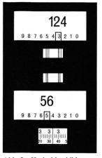
Abb. 8 Kreisablesebilder. 400<sup>g</sup> Horizontalkreis 56<sup>g</sup> 53<sup>c</sup> 34<sup>cc</sup> 360° Vertikalkreis 85° 35′ 14″
