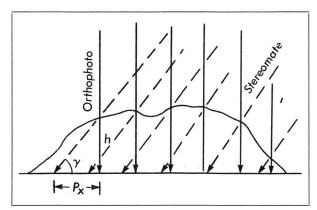
Abb. 1 Geometrische Grundbeziehungen der Stereoorthophotos
