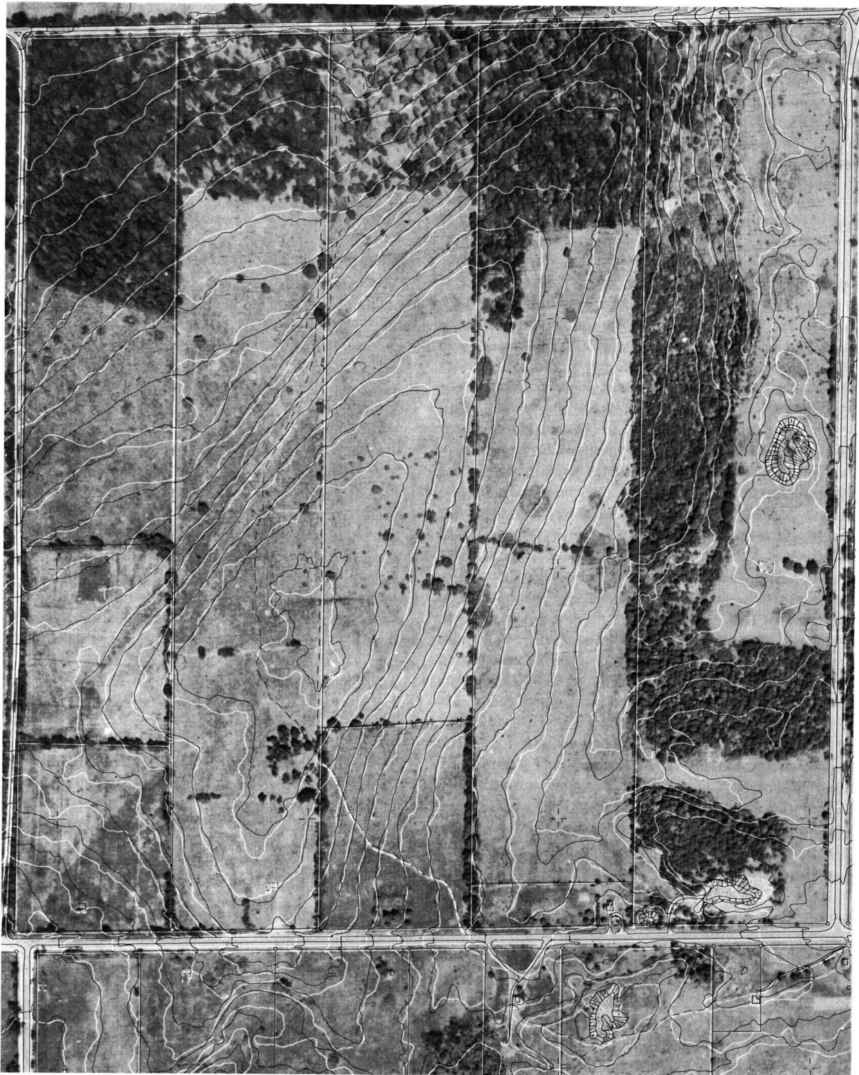
Abb. 7 Vergleich zwischen am Stereocompiler und am A-7 ausgeführten Auswertungen
