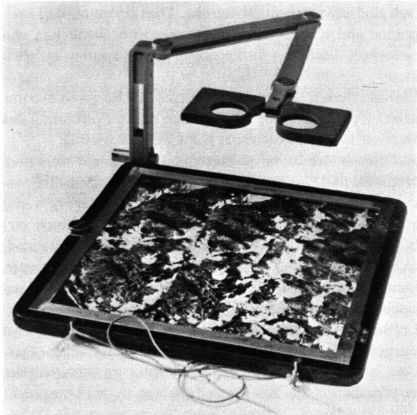
Abb. 6 Feldtisch für stereoskopische Auswertung mit einem zusammenlegbaren Stereoskop
