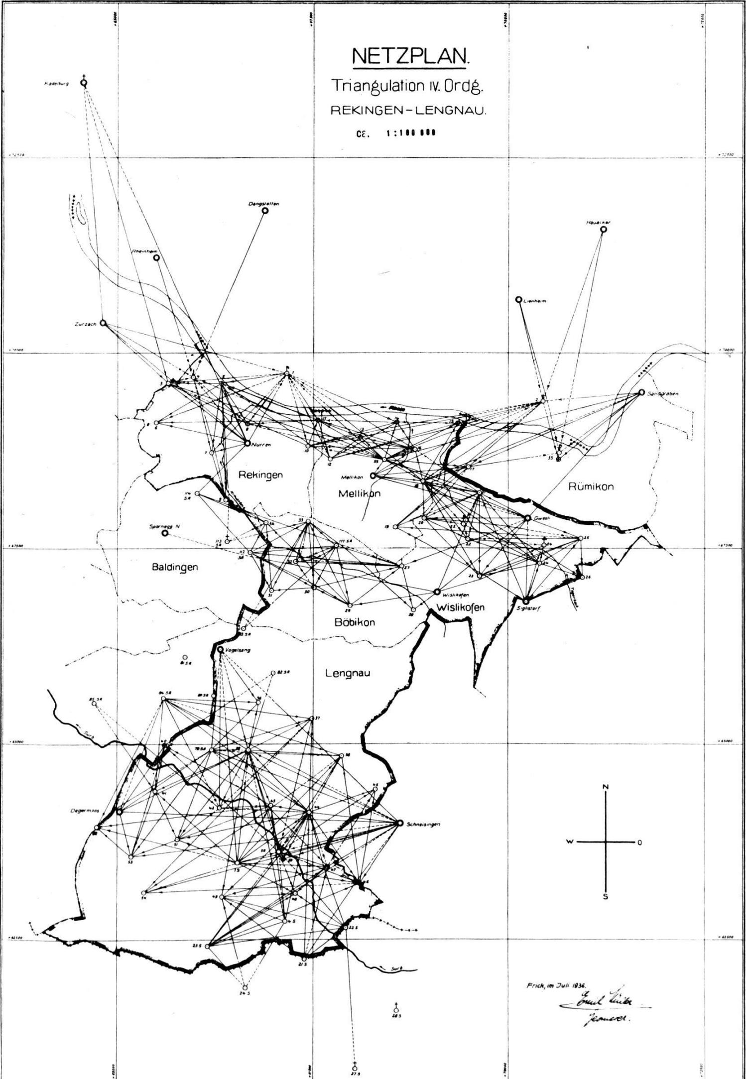
jektierung der Rheintalstrassenkorrektion durch das kantonale Tiefbauamt genauere Geländeaufnahmen notwendig wurden. Anlässlich der Übertragung dieser Aufnahmen an den Berichterstatter machte sich diese Lücke bemerkbar, und die fehlende Triangulation IV. Ordnung mußte nachgeholt werden. Es handelt sich um das Operat *Rekingen-Lengnau* mit insgesamt 59 Neupunkten.
