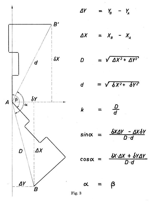
Ces calculs effectués, le calculateur garde en mémoire  $\sin \alpha$ ,  $\cos \alpha$  et k, les éléments de la transformation. Pour contrôle, il imprime les valeurs D et d. On ne devra continuer les calculs que si la différence D-d respecte les tolérances.
