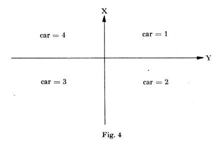
La valeur de la caractéristique détermine le choix du couple de formules à utiliser pour calculer les coordonnées Y et X d'un point à partir de celles du point précédent.
