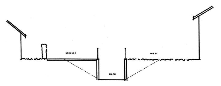
Bild 2: Skizze des Querprofils (nicht maßstäblich) über die beanstandete Bachkorrektion. Die gestrichelte Linie zeigt die Situation beim Bau von Böschungen, wie sie im offenen Gebiet allgemein angewendet werden.
