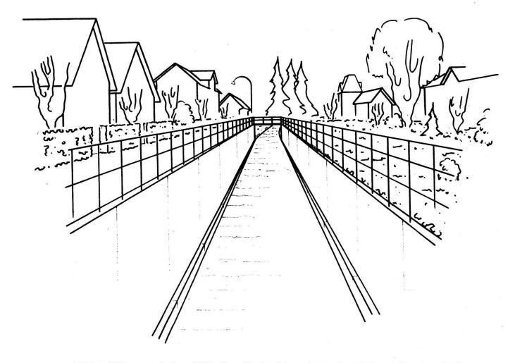
Bild 1: Skizze nach dem Bild über die Bachkorrektion im Wohngebiet. Im gleichen Sinne mußte seinerzeit der Dorfbach in Goßau SG korrigiert werden, und gegenwärtig ist in gleicher Weise im Zusammenhang mit einer Straßenverbreiterung der Dorfbach in Thal im Umbau begriffen.
