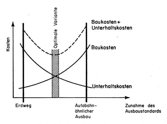
Fig. 3: Schema des Verlaufs der Bau- und Unterhaltskosten bei Zunahme des Ausbaustandards
