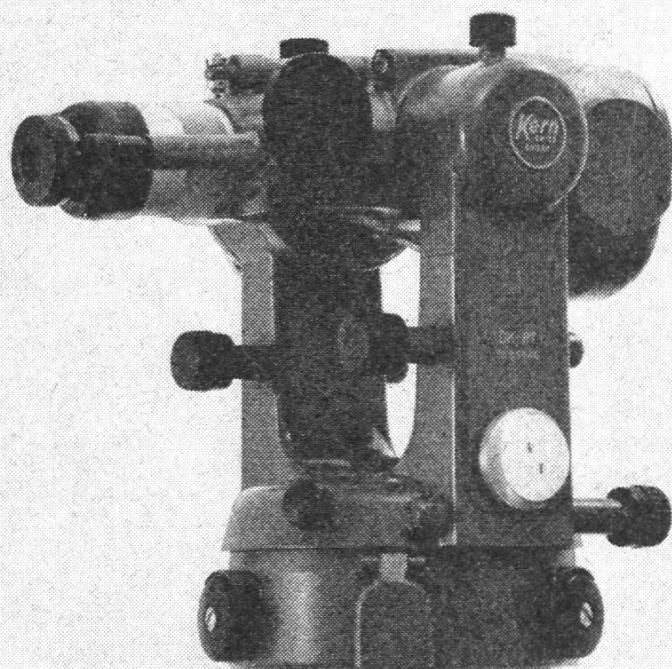
Kern DK-RT, das geeignete Instrument für Katastervermessung, Polygonierung und Absteckungsarbeiten hoher Genauigkeit
