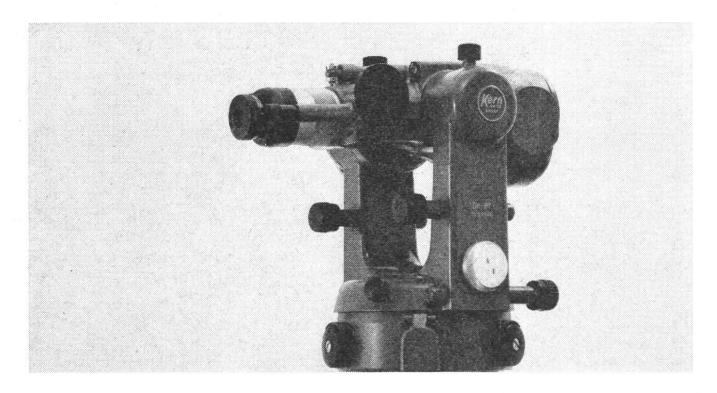
Kern DK-RT, das geeignete Instrument für Katastervermessung, Polygonierung und Absteckungsarbeiten hoher Genauigkeit
