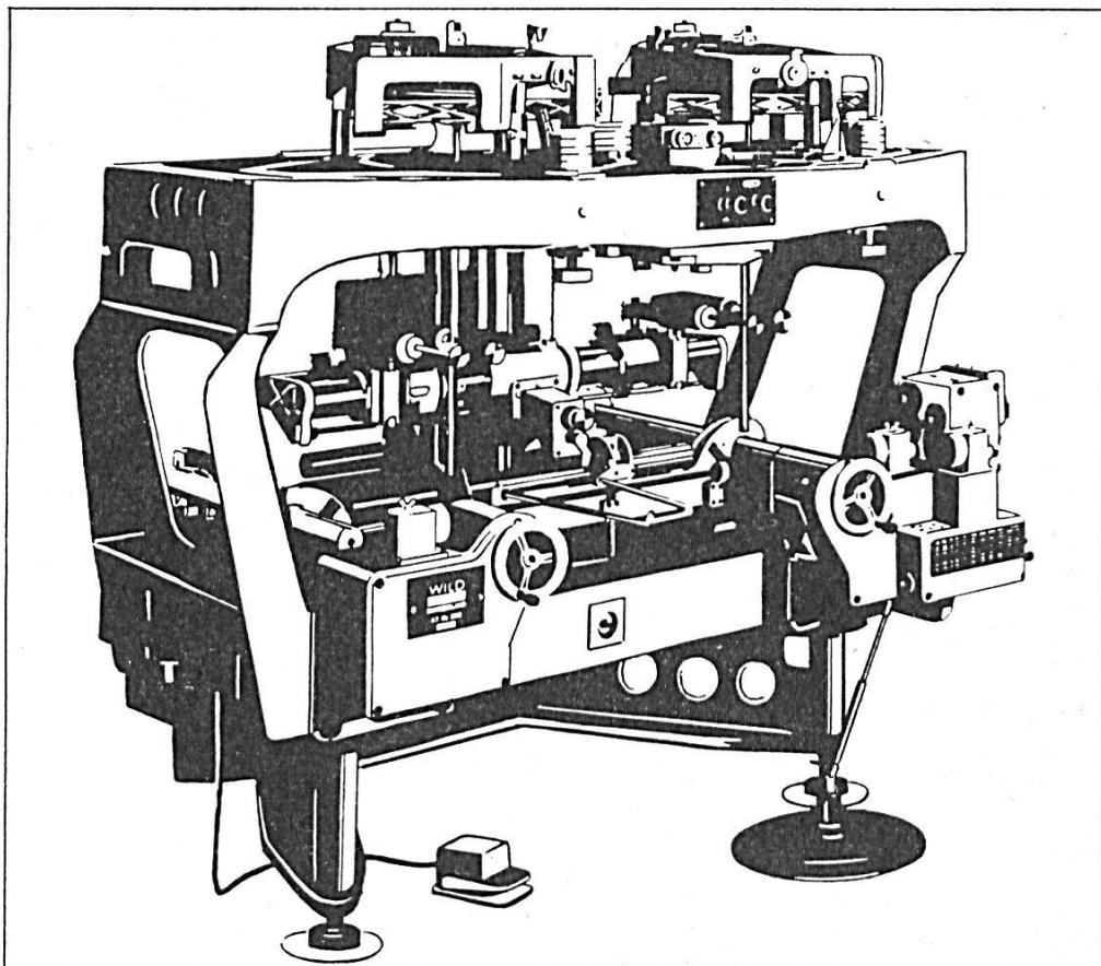
Der **Autograph Wild A7** ist ein Universalgerät 1. Ordnung für Aerotriangulationen und Kartierungen in allen Massstäben aus Luftbildern und terrestrischen Aufnahmen bis zum Format 23cm x 23cm (9" x 9") und mit einem Bildweitenbereich von 98 bis 215 mm. Elektrische Koordinatenregistrierung mit dem Wild EK5
