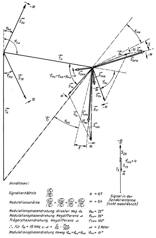
Figur 3: Empfangssignal: Vektordiagramm
