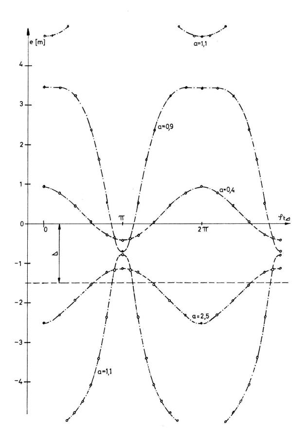
Swingverlauf e bei  $\varphi_{m\Delta}=153^\circ$
