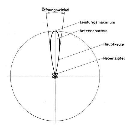
Figur 1: Strahlungsdiagramm einer Parabolantenne
