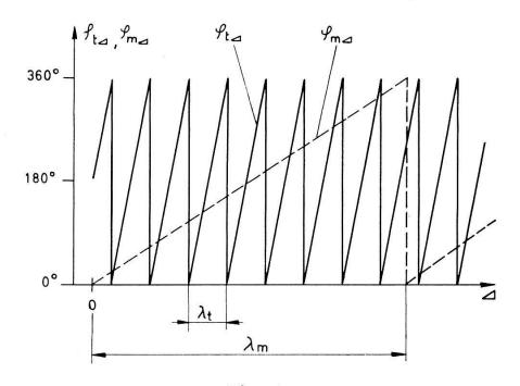
$\mbox{Figur 4:}$  Träger- und Modulationsphase  $\varphi_{t\varDelta}$  bzw.  $\varphi_{m\varDelta}$  als Funktion der Wegdifferenz  $\varDelta$
