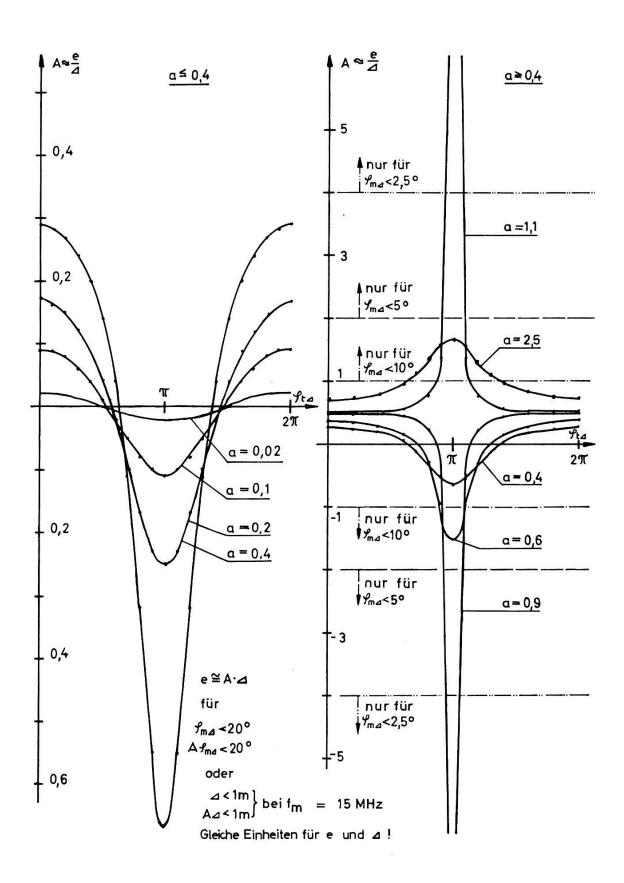
Figur 8: Normierter Swingverlauf A für kurze Wegdifferenzen  $\Delta$
