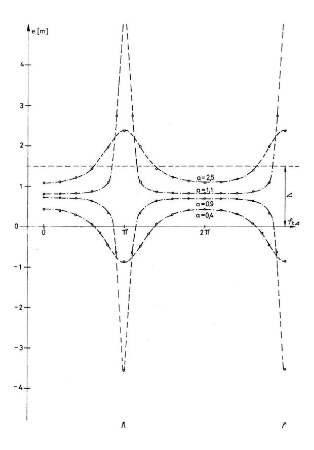
Swingverlauf e bei  $\varphi_{m\varDelta}\,=\,27^\circ$
