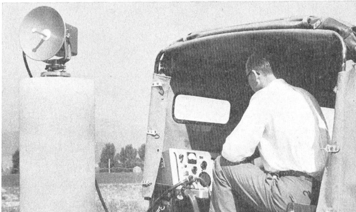
Der Wild DI 50 Distomat ist ein automatisches elektronisches Distanzmessgerät, das mit 3 cm-Trägerwellen arbeitet. Sein grosser Vorteil liegt in der Trennung von Mess- und Antennenteil, die, durch ein Kabel verbunden, bis zu 30 m voneinander aufgestellt werden können. Der Messteil kann daher im Fahrzeug oder an einem geschützten Standort bedient werden, während der Antennenteil auf einem Stativ, Gerüst oder Turm über dem Messpunkt steht.
